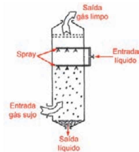
Figura 7.12 – Separador do tipo Spray
