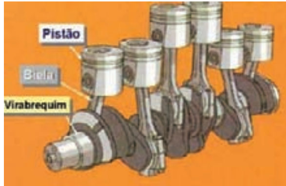
Figura 4.12 – Conjunto pistão, biela e eixo de manivelas ou virabrequim [REVISTA VIRTUAL TUDO SOBRE, 2008]
