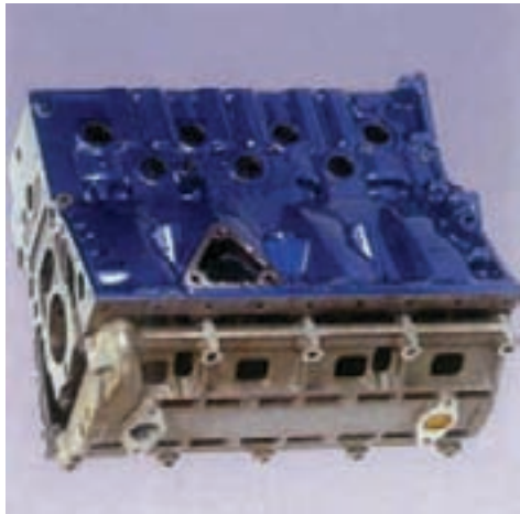
Figura 4.3 – Bloco de cilindros [REVISTA VIRTUAL TUDO SOBRE, 2008]
