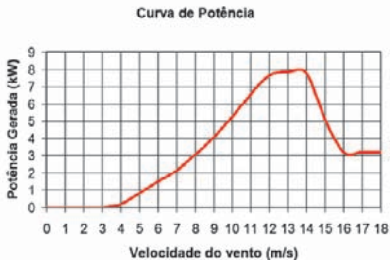
Figura 8.9 – Curva de potência de um aerogerador
