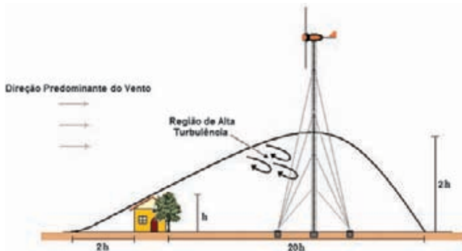
Figura 9.16 – Técnica de instalação de aerogerador
