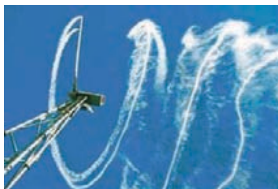
Figura 9.12 – Efeito esteira originado por um rotor eólico [WINDPOWER, 2007]
