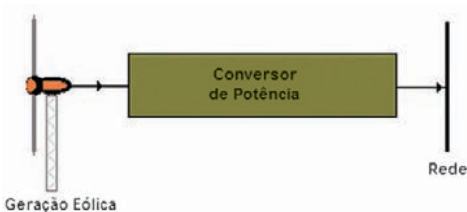
Figura 3.44 – Configuração típica de um sistema eólico interligado à rede
