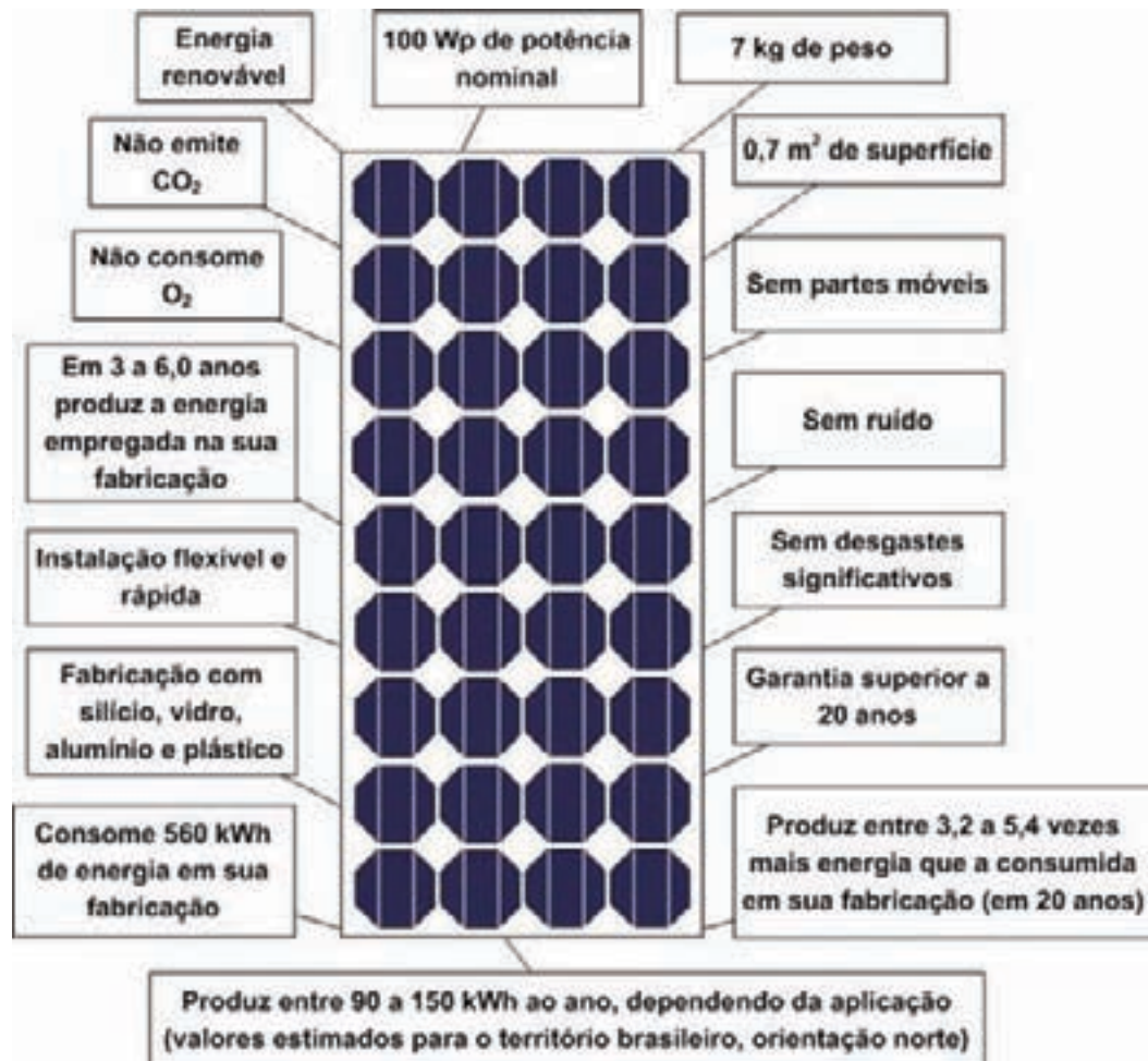
Figura 2.54 – Características dos módulos fotovoltaicos
