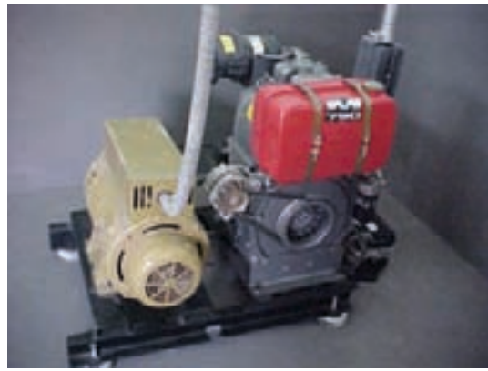
Grupo gerador a diesel
