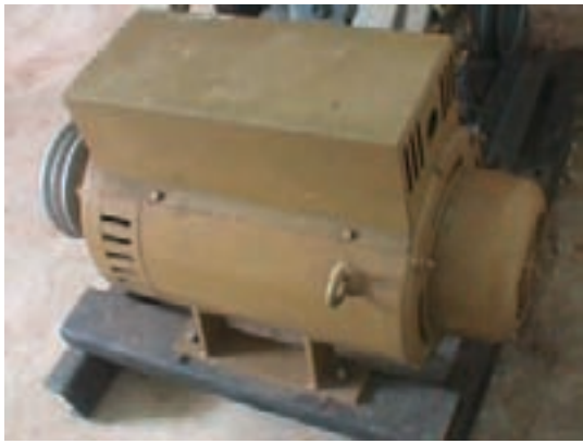
Gerador elétrico trifásico
