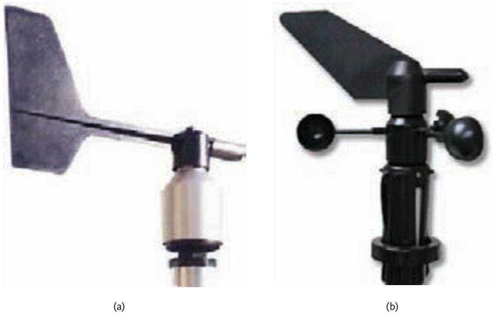
Figura 3.9 – Sensores de direção: (a) dispostos isoladamente; (b) integrados ao suporte do anemômetro
