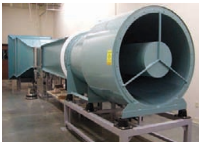
Figura 3.14 – Túnel de vento utilizado para a calibração de anemômetros Fonte: OTECHWIND, 2008
