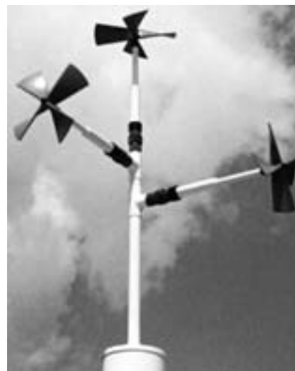
Figura 3.8 – Conjunto de anemômetros de hélices para medição das três componentes da velocidade de vento Fonte: ROHATGI e NELSON, 1994
