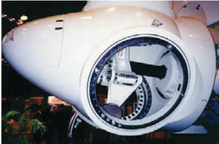
Figura 3.30 – Cubo de um aerogerador de grande porte
