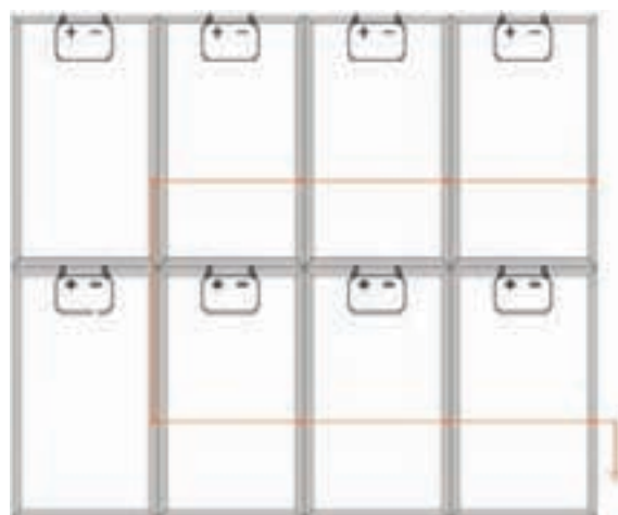
Figura 9.9 – Aterramento de módulos fotovoltaicos
