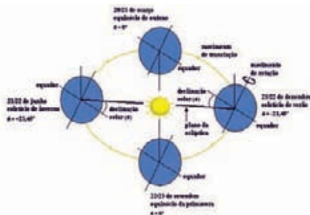
Figura 2.6 – Órbita da Terra em torno do Sol: posição da terra com relação ao Sol nos solstícios e equinócios
