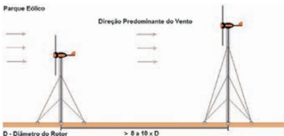
Figura 9.19 – Forma de instalação de aerogeradores com falta de espaço
