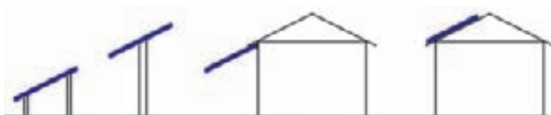
Figura 9.3 – Algumas formas de instalação de módulos fotovoltaicos
