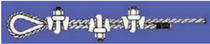
Figura 9.32 – Procedimentos para fixação dos cabos de aço aos esticadores
