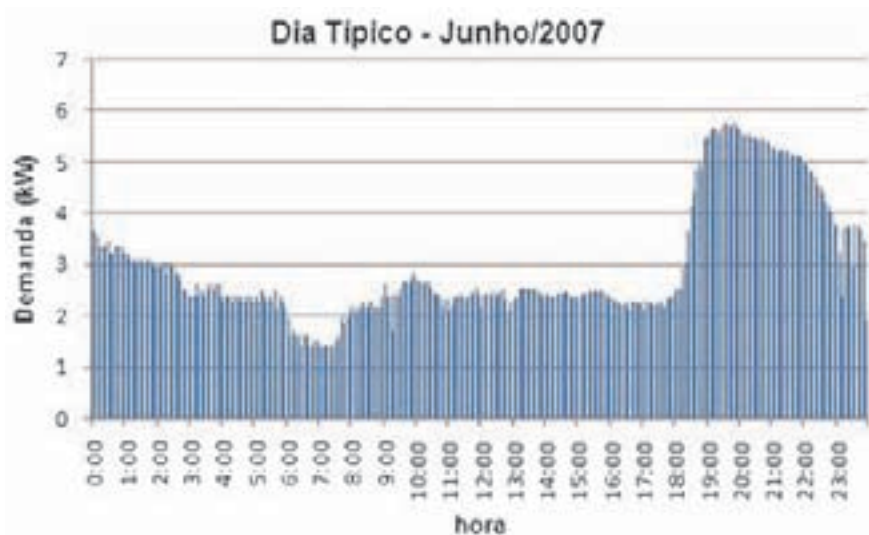
Figura 8.5 – Curva de carga de um dia típico do mês de junho/2007 em uma comunidade do estado do Pará, com 60 unidades consumidoras
